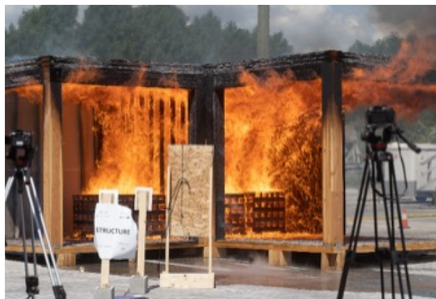
Image 9 - Test de résistance au feu à grande échelle sur une construction en bois lamellé-collé.
