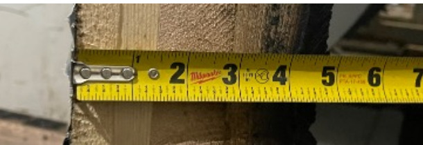
Image 10 - Surface carbonisée du CLT (en haut) et couche non carbonisée du panneau CLT (en bas) après exposition au feu.
