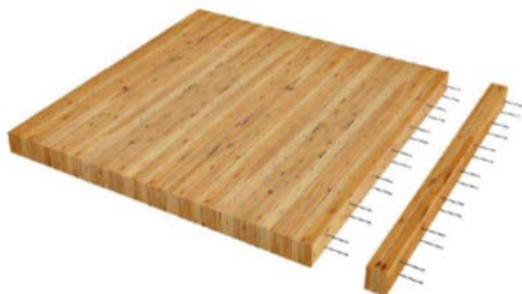
Image 6 - Structure/type d'assemblage du bois lamellé-collé, ou «NLT» (Le Conseil canadien du bois, juin 2018).
