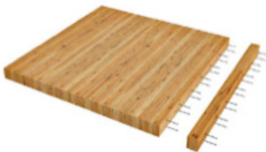
Figure 6 - Structure/assembly style of nail-laminated timber, or “NLT” (Le Conseil canadien du bois, juin 2018).
