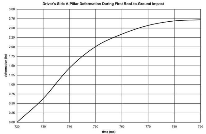
**Figure 23 – Driver’s A-Pillar Deformation**
