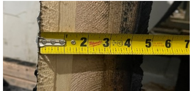
Image 10 - Surface carbonisée du CLT (en haut) et couche non carbonisée du panneau CLT (en bas) après exposition au feu.
