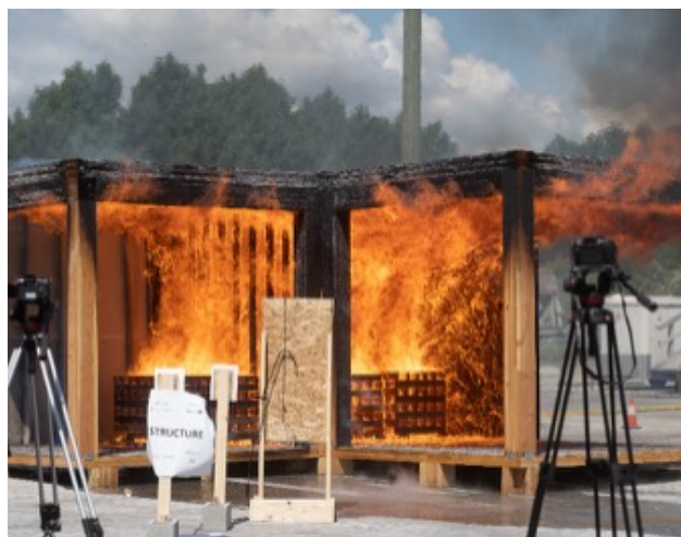
Image 9 - Test de résistance au feu à grande échelle sur une construction en bois lamellé-collé.
